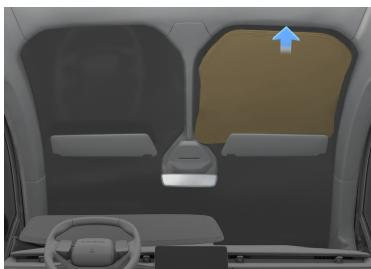
6. Trekk sidene av solskjermen varmsomt innover, slik at sideklemmene (2, 3) kan skli inn mellom panelet og glasset.
