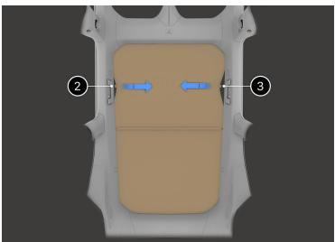
8. Stelle sicher, dass die flache Oberfläche aller Clips der hinteren Sonnenblende sicher zwischen Verkleidung und Glasscheibe sitzt.
