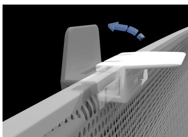
Når du monterer skjermene foran og bak, sørger du for at den flate overflaten på alle solskjermklemmene er festet mellom panelet og glasset.
