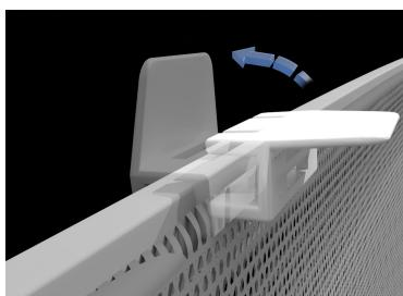
Stelle beim Einbau der vorderen und hinteren Sonnenblenden sicher, dass die flache Oberfläche aller Sonnenblenden-Clips sicher zwischen Verkleidung und Glasscheibe sitzt.
